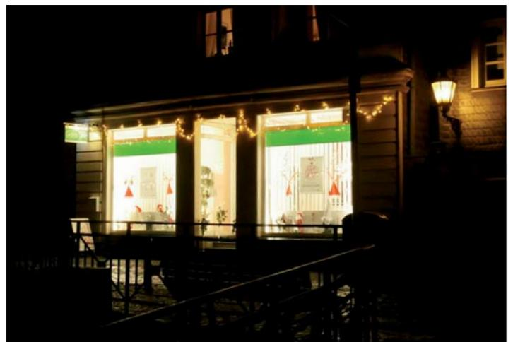
Im Vergleich zu den niedrigen Umgebungsleuchtdichten weist dieses Schaufenster in der Hauptstraße extrem hohe Leuchtdichten und eine kühle Farbtemperatur auf.
