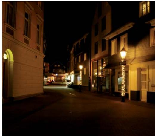
Hohe Leuchtdichten auf den Fassaden stehen im Widerspruch zu den teils mäßig ausgeleuchteten Verkehrsflächen.
