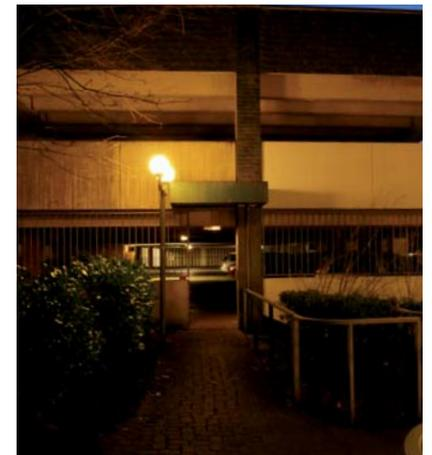
Freistrahlende Lichtquellen geben das Licht ohne Lichtlenkung in den oberen Halbraum ab.
