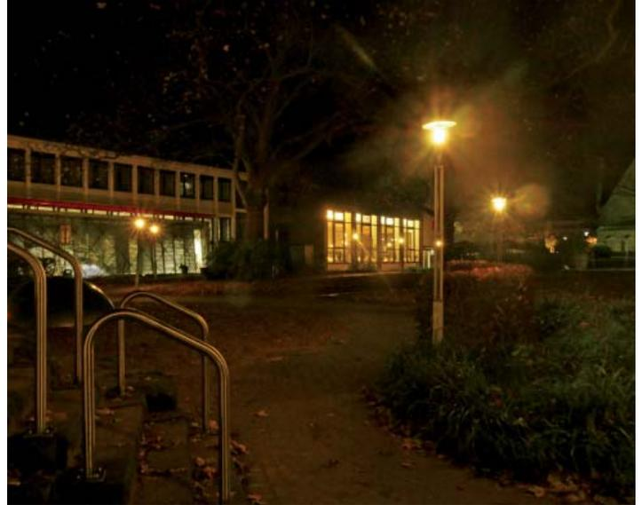
Die veralteten Pilzkopfleuchten mit freistrahrender Lichttechnik beleuchten die Fußwege nur unzureichend, sodass die Wegeverbindung nachts ein Gefühl der Unsicherheit vermittelt. Die Leuchten sind zum Teil defekt und in baulich schlechtem Zustand.
