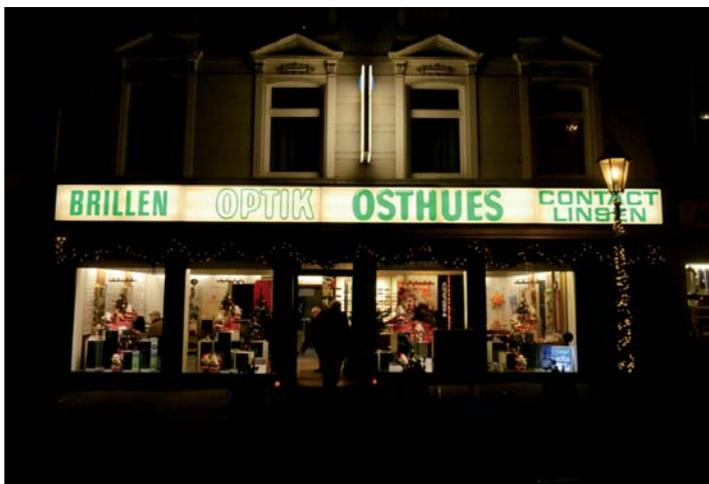
Im Vergleich zur Umgebung weist diese selbstleuchtende Werbetafel extrem hohe Leuchtdichten auf und verursacht Blendung. Das Schaufenster, eigentlicher Anziehungspunkt, tritt visuell in den Hintergrund.
