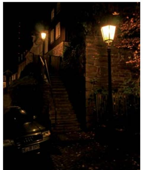
Die Gassen und Treppen werden durch das Streulicht der freistrahrenden Leuchten schwach erhellt. Dabei werden vor allem die vertikalen Flächen beleuchtet, was der Gesichtserkennung zugute kommt. Gleichzeitig erreicht kaum Licht die horizontale Nutzfläche, sodass die Treppen zu Stolperfallen werden.
