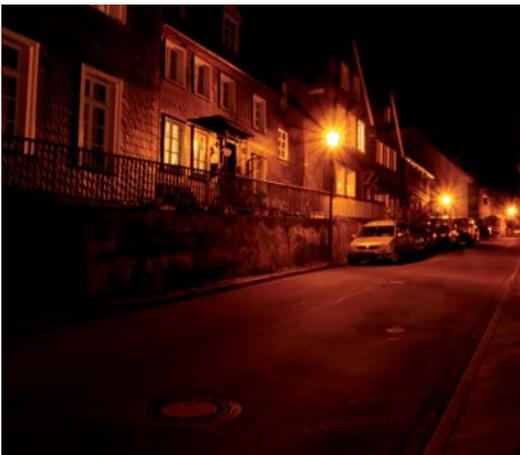
Hohe Leuchtdichten auf Fassaden stehen im Widerspruch zu den teils mäßig ausgeleuchteten Verkehrsflächen.
