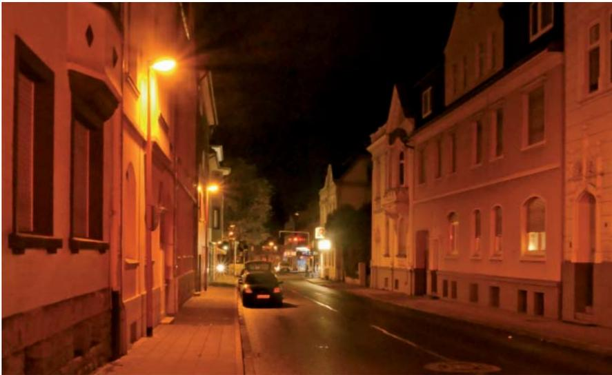
Hohe Leuchtdichten auf Fassaden stehen im Widerspruch zu den teils mäßig ausgeleuchteten Verkehrsflächen.
