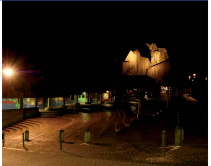
Die mastbefestigten Pendelleuchten auf der Mauer entlang der Löher Straße sind nicht in Betrieb. Der vordere Bereich des Domvorplatzes wird durch einen Strahler geflutet, dessen Ausrichtung ein hohes Maß an Blendung verursacht. Die Präsenz vieler dunkler, uneinsehbarer Ecken mindert das subjektive Sicherheitsgefühl auf dem Platz.
